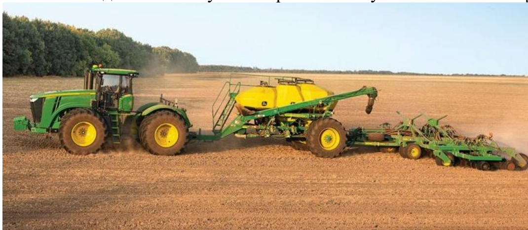
Рисунок 1 – Общий вид широкозахватного пневматического посевного комплекса John Deere 1890 для прямого посева
