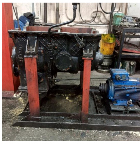
Рис. 3 – Корпус КПП перед сборкой деталей
