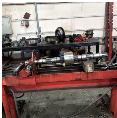
Рис. 2 – Верхний вал КПП после разборки бустеров
