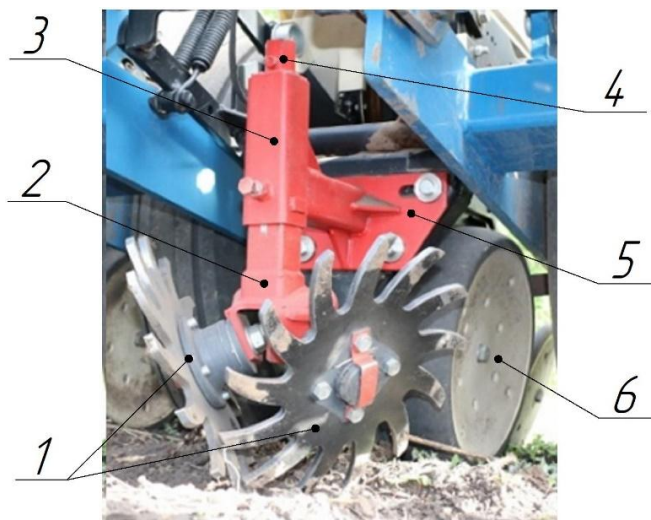
Рисунок 1 – Ротационный очиститель рядка АгриФокус АФ-350х10, установленный на высевающей секции пропашной сеялки Kinze 3000:
