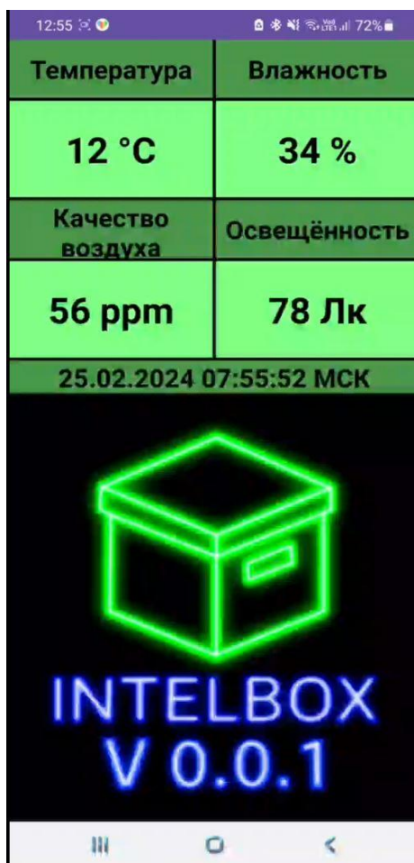
Рисунок 3 — Приложение для системы Android для отображения показателей микроклимата в реальном времени
